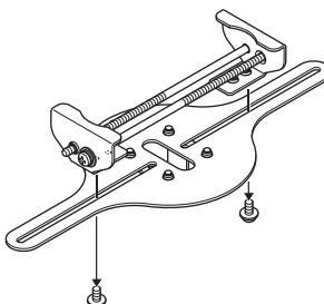
2. 大型用ツメ金具をM4ネジ(4本)で取り付ける
