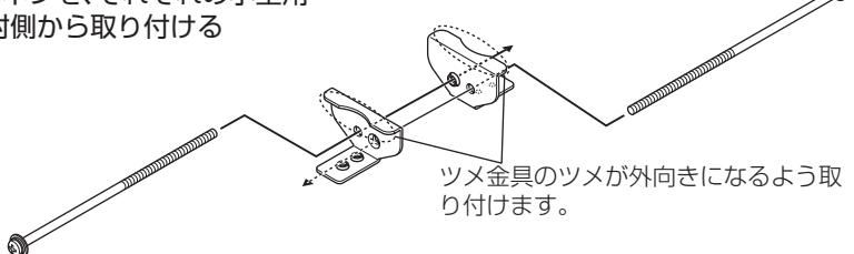
4. 小型用取付金具をM4ネジ(2本)で取り付ける
