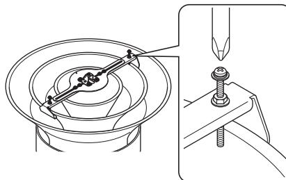
**参考:** コーンの大きさによっては、プレートに大型用ツメ金具を固定しているネジ位置を外側にしたほうが安定して取付られる場合があります。
