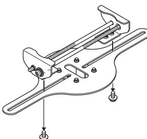
2. 台座を固定しているM4ネジ(4本)を外し、台座をプレートから外す
