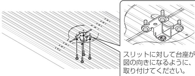
**参考:** 格子のサイズやスリットの間隔によっては、プレートの位置を格子やスリットに対して斜めに取り付けることもできます。
