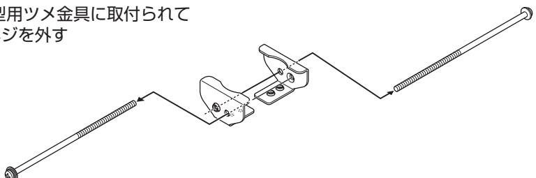
3. 外したM5調節ネジを、それぞれの小型用ツメ金具の反対側から取り付ける
